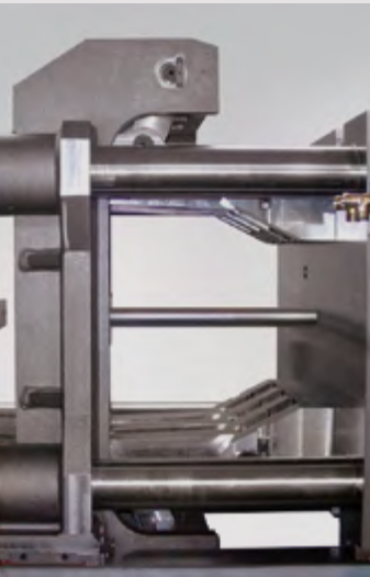
Sistema chiusura brevettato a ginocchiera esterna. Patented clamping system with external toggle.
