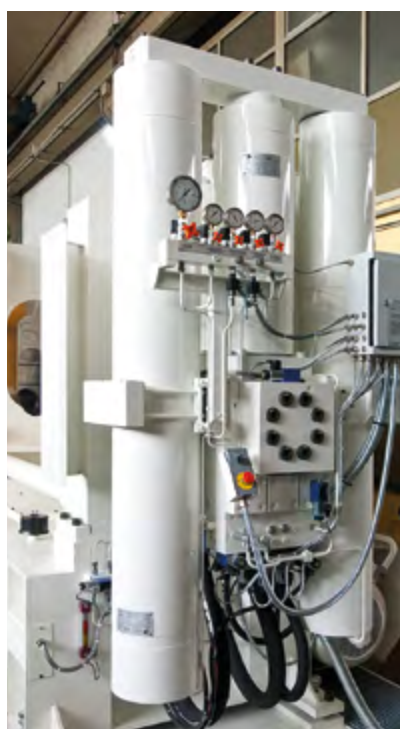
Compensatore automatico pressione azoto. Automatic compensator of nitrogen pressure.
