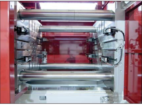
Maschinenplatten aus geschmiedetem Stahl mit Edelstahlauflege.
