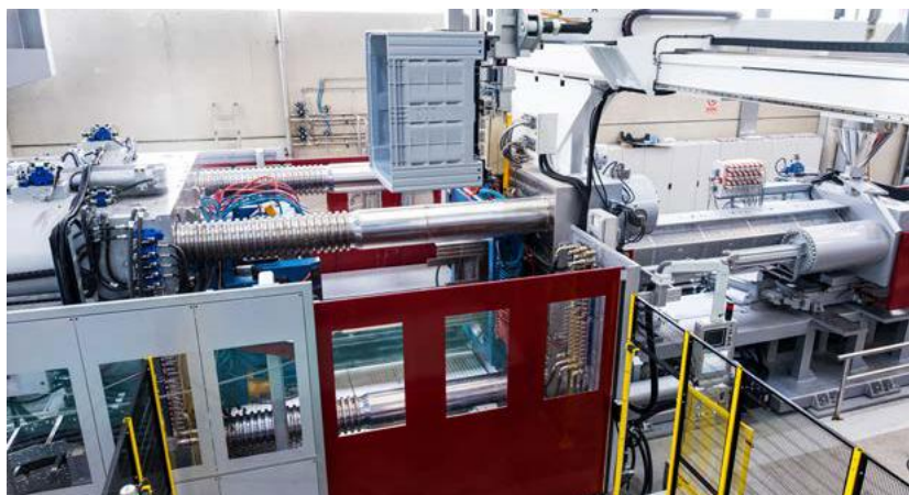
Hydro 5000 con relativo robot in fase di estrazione pezzo con mano di presa dedicata
