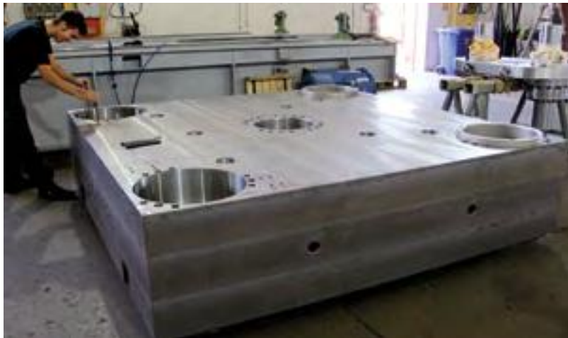
Piani ricavati da monoblocchi di acciaio forgiato in Italia Machine platens are made from monoblocks of Italian forged steel. Plateaux d'acier mono bloc usiné en Italie
